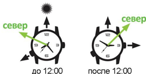
**5** Поверните заводную головку, расположенную на восемь часов, чтобы соответствующим образом расположить кольцо компаса.
